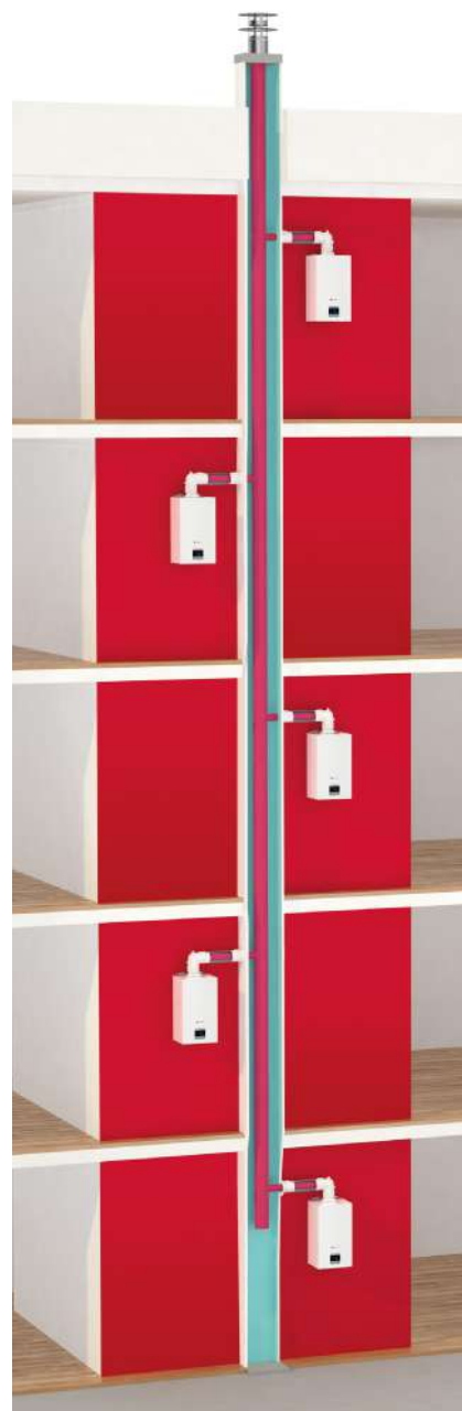
Conduit collectif 3CEp avec 5 chaudières M-Condens 3CEp
